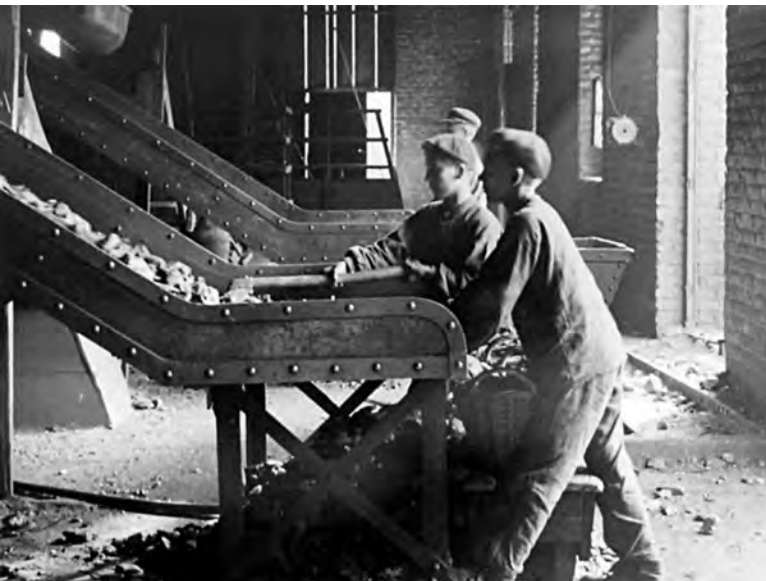
Photographie réalisée par Gustave Marissiaux : enfants au pied d'une trémie de triage à la Société de la Nouvelle-Montagne, 1904-1905, Engis. (Liège, Musée de la vie wallonne, coll. Gustave Marissiaux, série « La Houillère », n° MVW-1026264-807).
